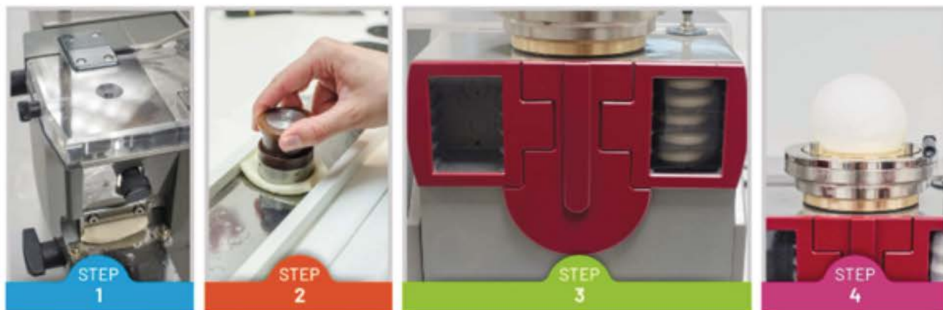
Figura 1: la serie de pruebas del alveógrafo de CHOPIN Technologies, incluye componentes para mezclar harina y agua salada, cortar muestras de masa e inflar automáticamente cada pieza de masa para medir sus propiedades reológicas.
