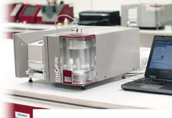
calentar la masa proporciona información sobre el debilitamiento de las proteínas (volumen), la estructura de la masa y la actividad de la amilasa (relacionada con el color del producto). A continuación, tras el calentamiento, el instrumento también proporciona información sobre la vida útil del producto midiendo la retrogradación del almidón.
